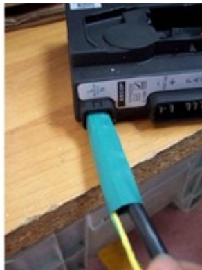
11. ábra: példa a dupla szigetelésű kapcsolatra
