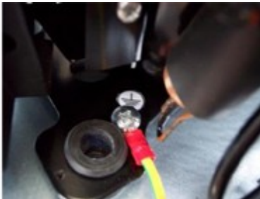
12. ábra: A földkábel csatlakoztatása a kompresszor fém részén
