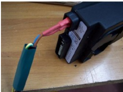
11. ábra: példa a dupla szigetelésű kapcsolatra
