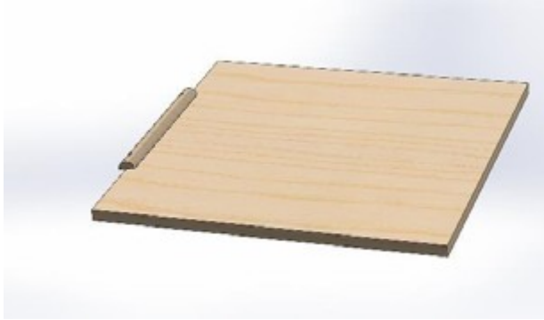
7. ábra: Fából készült tartozék az evaporátor hajlításához
